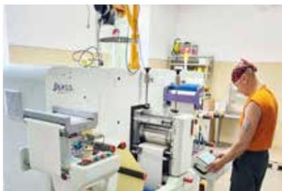
RD330/370 и RDF 330/420 — популярные машины монолитной конструкции для финишной обработки этикетки разработки и производства компании Vision. Название включает рабочую ширину в миллиметрах. Машина может быть при изготовлении сконфигурирована для широчайшего спектра финишной обработки не только самоклеящейся этикетки, но и самой разнообразной продукции, включая листовую продукцию, картонную коробку, стикеры, IML этикетку и прочее.
