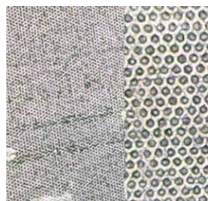
Фото при помощи микроскопа ячеек анилокса до очистки и после очистки
