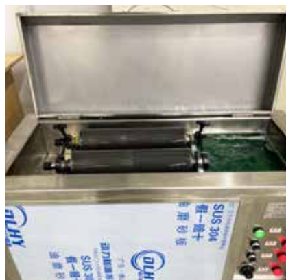
Устройство ультразвуковой очистки анилоксовых валов DLHY в работе
