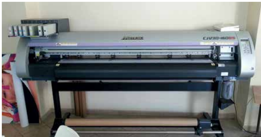
Рис. 2. Широкоформатный сольвентный плоттер Mimaki CJV30-160BS
