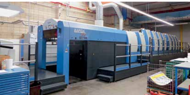
Восьмикрасочная Rapida 106 с переворотом листа для печати 4+4, дополнительной лакировальной секцией и оснащением для LED-UV
