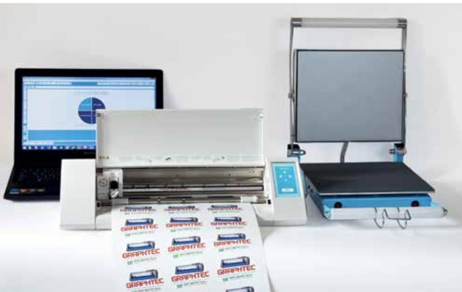
продлевает срок службы ножа и марзана. Также для качественной сквозной резки у плоттера имеется функция с настраиваемым шагом резки и длиной перемишки. Это позволяет вырезанному элементу продолжать удерживаться в материале до окончания резки, после чего его очень легко выдвинуть.
