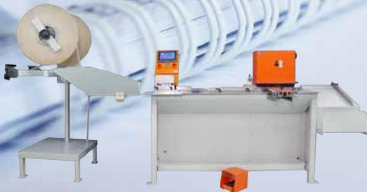
Полуавтоматический брошюровщик ЛБ-350 — это переплётный аппарат для работы с металлической пружиной. Предназначен для брошюровки проволокой WIRE'O. Особенно подходит для работ, где обложка больше внутреннего блока. Машина исполнена в напольном варианте и установлена на подставке.
