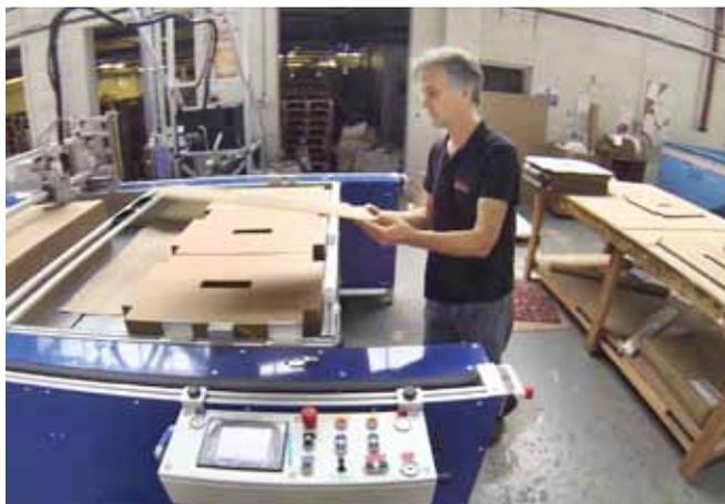
На координатном устройстве клей можно наносить как прямыми линиями, так и любыми другими кривыми, которые могут быть описаны на плоскости XY. Рабочей зоной оператора является любая из сторон машины в зависимости от типа продукции, изготавливаемой в данный момент.
