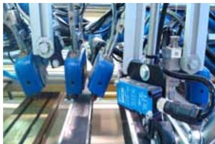
В линейной системе для увеличения числа наносимых полос клея нужно устанавливать большее число термopистолетов, а также использовать специальные форсунки с большим числом отверстий.
