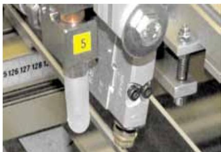
В координатной системе необходим всего один термopистолет, который может быть максимально спарен с головкой холодного клея, что достаточно для нанесения любого рисунка клея на любой точке поверхности заготовки.
