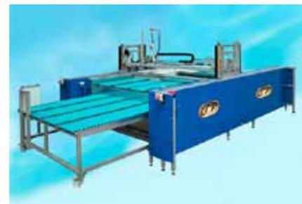
Специальная модификация Bickers TapeJet — машина для координатного нанесения скотча. Максимальная рабочая площадь — 1,9 х 3 метра, может оснащаться системой автоматической выгрузки готового образца.
