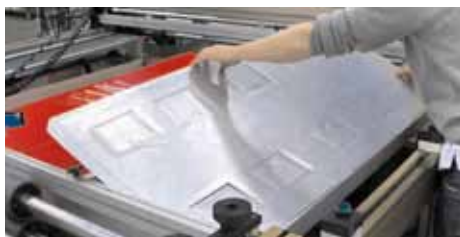
Приклейка дополнительного элемента на поверхность заготовки
