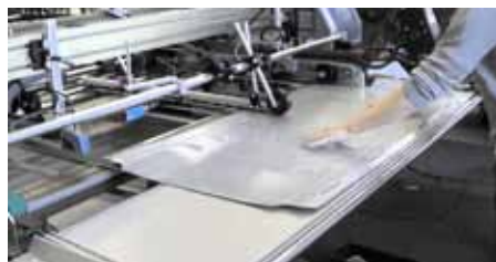
Подача заготовки в машину для нанесения клея на её поверхность
