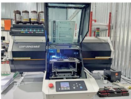
2. Сначала в парке оборудования появился Mimaki UJF-3042FX, который позволяет печатать на жестких материалах до А3 формата толщиной до 50 мм. Основное преимущество — принтер самостоятельный и автоматизированный. Кроме того, есть Mimaki UJF-3042 MKII — его «старший брат», он позиционирует детали до 15 см. На нем делаем, например, круговую печать на бутылках, печатаем шрифтом Брайля. Эти модели — топовые на рынке, при этом самые надежные, поэтому у нас не было причин рассматривать другие варианты.
