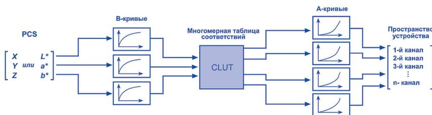
Рис. 2. Пример способа преобразования данных о «цвете» от цветовых координат до цветового пространства печатного устройства.
