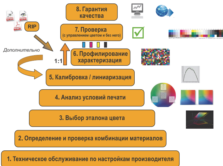
Рис. 1: Общие принципы управления технологическим процессом для цифровой печати.
