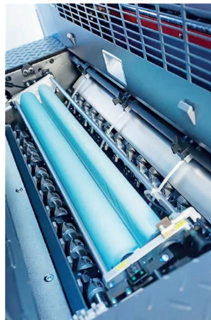
**Значение офсетного резиноканевого полотна в полиграфическом производстве сложно переоценить. Офсетная резина отвечает за перенос красочного слоя с офсетной формы на бумагу, перенося изображение с металлической пластины. Помимо этого, резиноканевое полотно компенсирует вибрацию в процессе печати, транспортирует бумагу в печатной машине. А также обеспечивает сохранение формы растровой точки на различных бумагах.**
