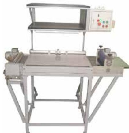
что обеспечивает запас тепла и стабильность при наличии сквозняков в помещении как при добавлении воды в клеевую массу, так и при добавлении клея в клеевую массу. При этом нет необходимости дожидаться расплавления клея в общей клеевой массе. Контроль температуры интегральный, чем далеко не всегда могут похвастаться иные аналоги, а также более производительные и дорогие машины.
