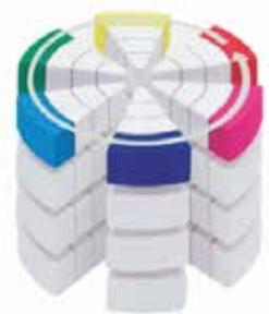
Рис. 8. Иллюстрация цветового тона в цветовом пространстве LCh
