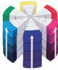
Рис. 6. Иллюстрация светлоты в цветовом пространстве LCh
