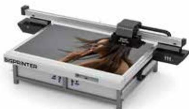
Профессиональная версия УФ-планшетного принтера с большим размером стола с размером капли 6 пкл. Технические характеристики и параметры: разрешение печати — 720х2880 dpi; размер печатного поля — 2,02х3,1 м; толщина материала — 105 мм; направление печати — одно-, двунаправленная печать; количество печатающих голов — четыре-восемь; цветовая модель — СМУК, Lc, Lm, White, Varnish; программное обеспечение — OnyxRipCenter.
