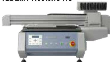
Сувенирный планшетный компактный настольный принтер для высококачественной печати на любых плоскостях: пластик, дерево, стекло, керамика, кожа, камень, металл. Прост в эксплуатации. Технические характеристики: разрешение печати — 1440х2880 dpi; размер печатного поля — 0,4х0,6 м; толщина материала — до 15 см; чернила — СМУК + СМУК, СМУК + WWWW; система отверждения — UV LED; программное обеспечение — Windows XP/98/2000/Win7; интерфейс — USB 2.0; вес — 90 кг.
