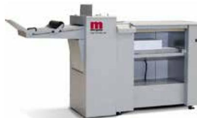
нескольких вариантов оборудования, основными критериями при выборе были работа с форматами до 700 мм, продольная и поперечная перфорация, фальцовка по нескольким программам и стоимость оборудования.
